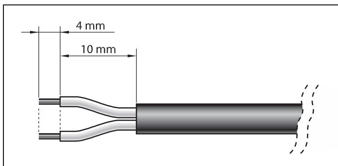
Pak pokračujte montáží **ŠEDÉ** zásuvky typu "L" na konci kabelu panelu, a to následujícím způsobem:
