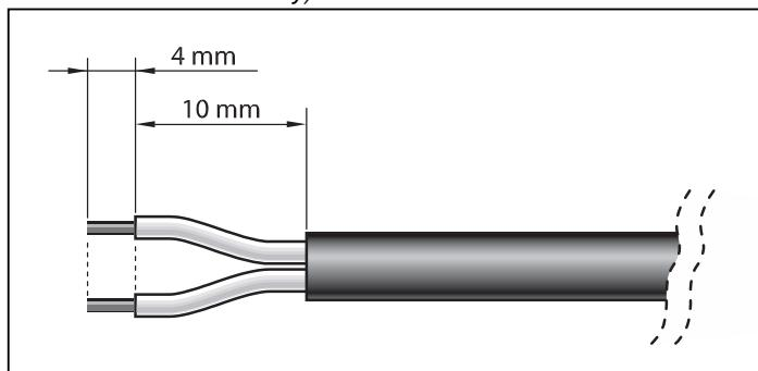
Pak pokračujte montáží **ČERNÉ** zásuvky typu "L" na konec silového kabelu, a to následovně:
