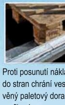
Proti posunutí nákladu do stran chrání vestavěný paletový doraz na profilu rámu.
