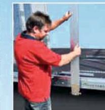
Zajištění nákladu zaručují rozpěrné tyče na střeše a vodící děrované lišty v podlaze.
